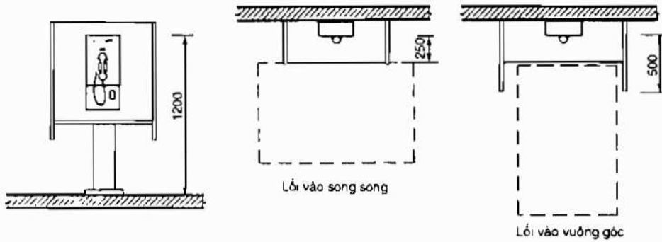
Hình 54: Điện thoại công cộng cho người tàn tật sử dụng
