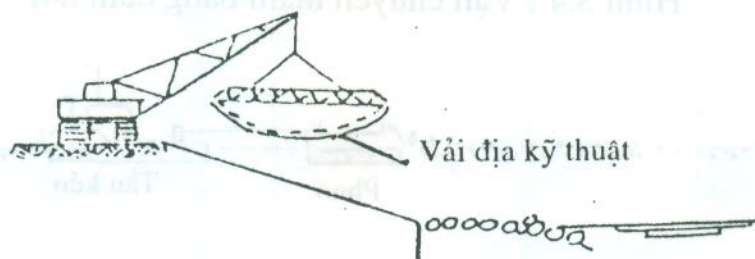
Hình 3.2 : Đặt thảm lấp sẵn
